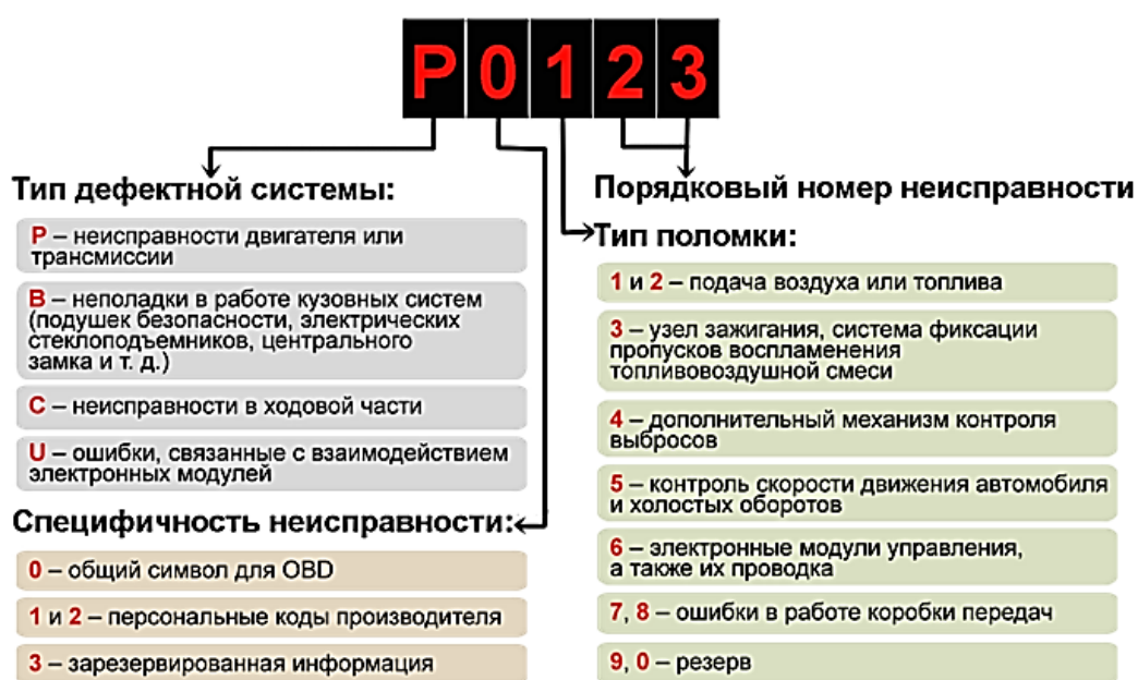
Рис. 5.1. Состав и строение кодов и ошибок неисправностей
