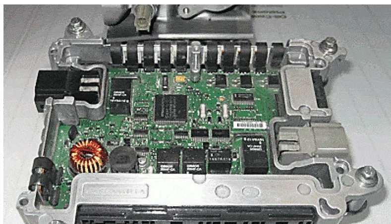
Рис. 1.2. Электронный блок управления
