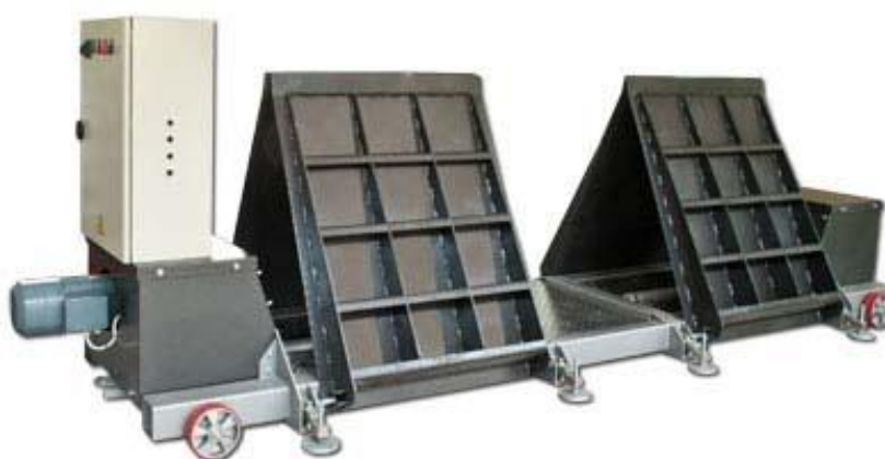
Рис. 3.5. Универсальный мобильный тормозной стенд «STENTOR» в сложенном состоянии
