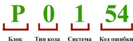
Рис. 9.1. Структура кодов неисправностей
