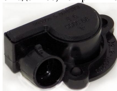
Рис. 1.6. Датчик положения дроссельной заслонки
