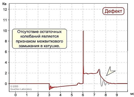
Рис. 4.7. Дефект катушки зажигания- межвитковое замыкание
