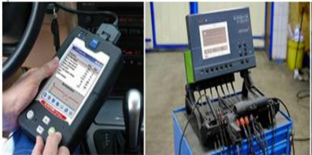
Рис. 2.10. Портативный автосканер, мотор-тестер, оборудование для диагностики
