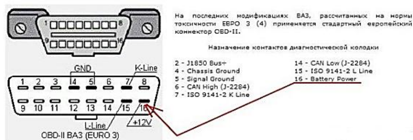
Рис. 6.2. Схема разъема OBD II
