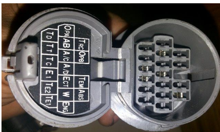
Рис. 8.2. Разъем для подключения диагностического оборудования
