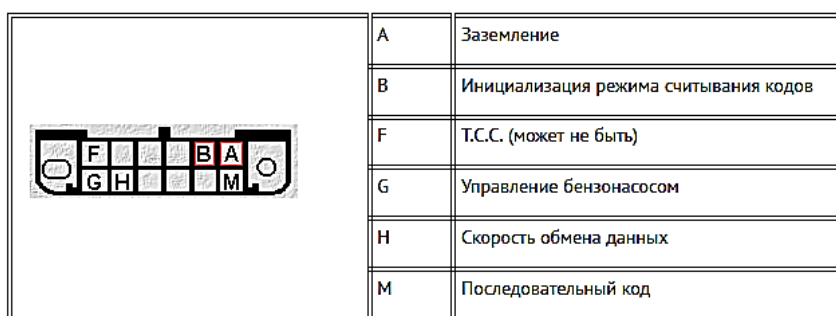
Рис. 10.1. Схема диагностического разъема
