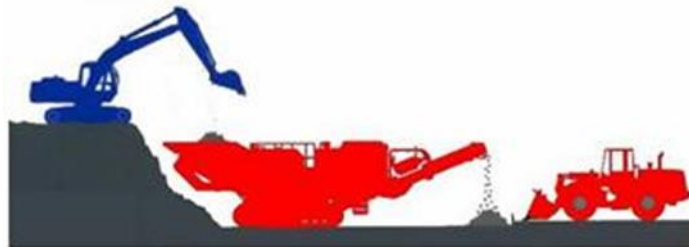
Рисунок 3.43 - Дробление с помощью дробильной установки
