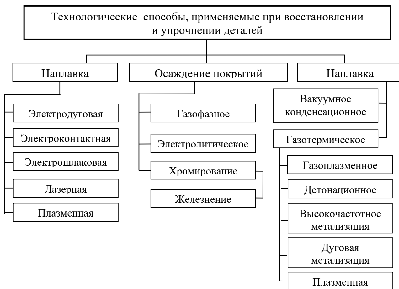
Рис. 2.47. Классификация технологических способов, применяемых при восстановлении и упрочнении изношенных деталей, сборочных единиц машин и оборудования
