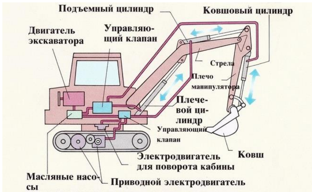
Рисунок 2.36 – На поворотной платформе смонтирован двигатель внутреннего сгорания с воспламенением от сжатия
