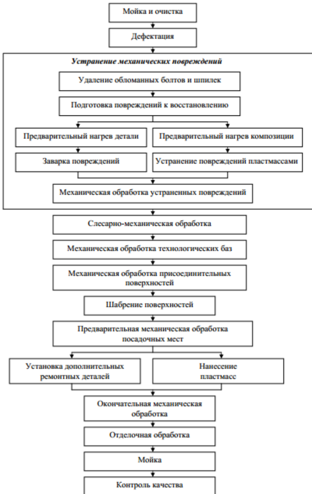
Рисунок 3.2 – Структура технологического процесса восстановления корпусных деталей
